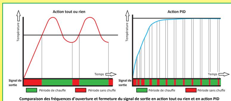
Si l'action PID permet d'affiner la régulation dans un certain nombre de configurations, elle a cependant l'inconvénient de faire cycliser le signal de sortie très rapidement, ce qui réduit fortement la durée de vie des contacteurs électromécaniques, et oblige dans la plupart des cas à recourir à des relais statiques.
