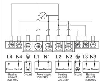
**Câblage:** alimentation de puissance Neutre + Phase + Terre sur un bornier 6mm<sup>2</sup>, et sortie vers 3 circuits de chauffage en 1.5 ou 2.5mm<sup>2</sup>.
