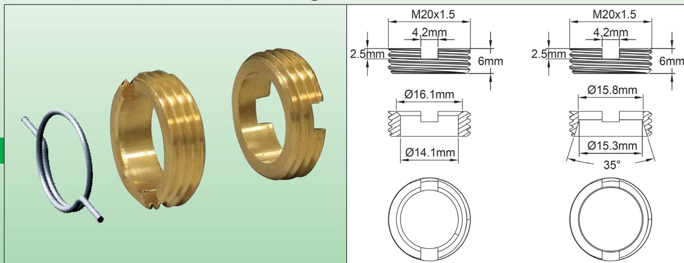
Les garnitures de presse étoupe sont comprimées entre deux écrous, l'un avec portée plate, situé à l'intérieur du coffret ou de la platine, l'autre avec une portée conique, et qui se monte à l'extérieur.
