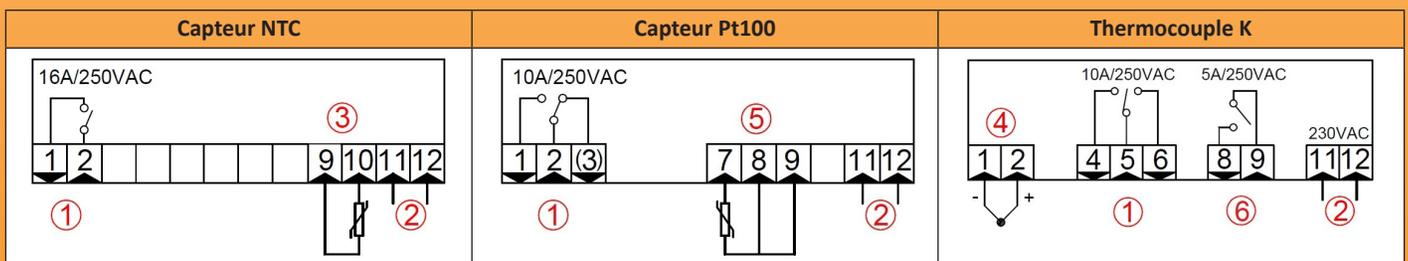
1: Sortie relais ; 2: Alimentation 230V alt ; 3: Capteur NTC ; 4: Capteur thermocouple K ; 5: Capteur Pt100 ; 6: Sortie relais d'alarme.
