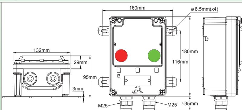
3 x 16A (AC1), 250V, bornier 5 bornes à vis 2.5 mm<sup>2</sup> et 5 bornes à vis 6 mm<sup>2</sup>. Voyant rouge de mise sous tension et voyant vert de sortie (250V), couvercle transparent.
