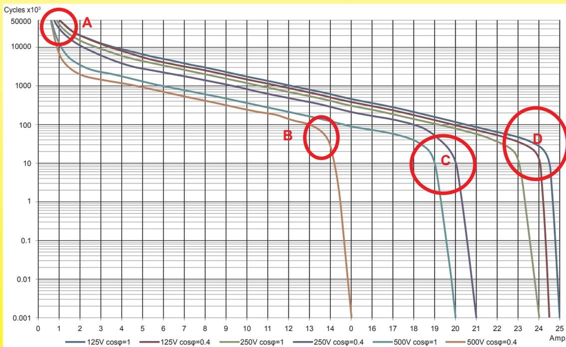
Valeurs indicatives moyennes, pour un mécanisme à rupture brusque, avec contacts en argent.
